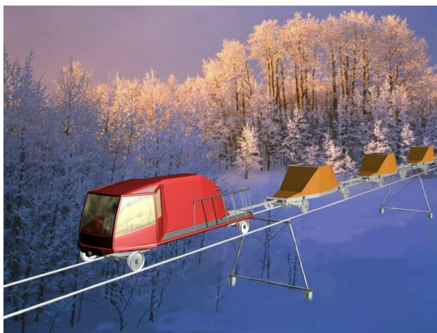
Рис. 2. Эшелон грузовых модулей для перевозки сыпучих грузов
