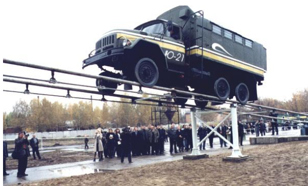
Рис. 5. Модифицированный ЗИЛ-131 на струнном пролете длиной 24 м (октябрь 2001 г.)
