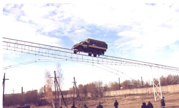
Рис. 6. Модифицированный ЗИЛ-131 на струнном пролете длиной 48 м (ноябрь 2004 г.)
