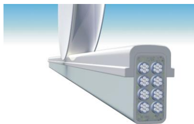
Рис. 5. Конструкция (вариант) рельса-струны и колеса
